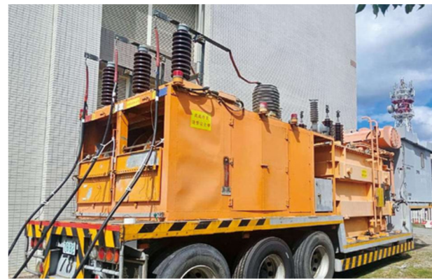
台電綜合研究所提供移動式電力設備試驗裝置（Mobile Voltage Regulating Transformer, MVRT）試驗電源。
